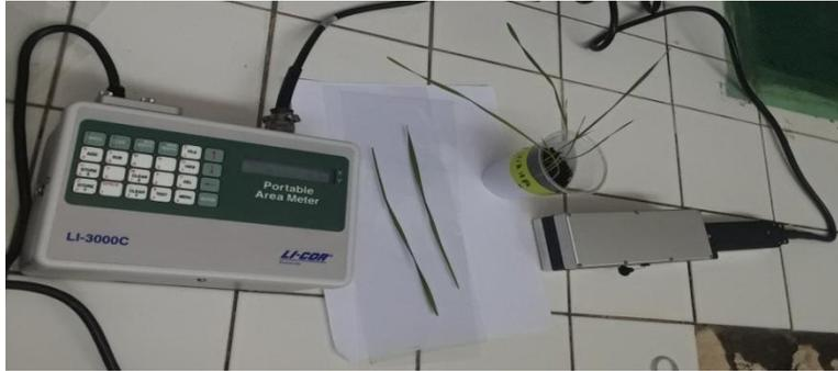
الشكل 14: صورة جهاز Portable Area metre
